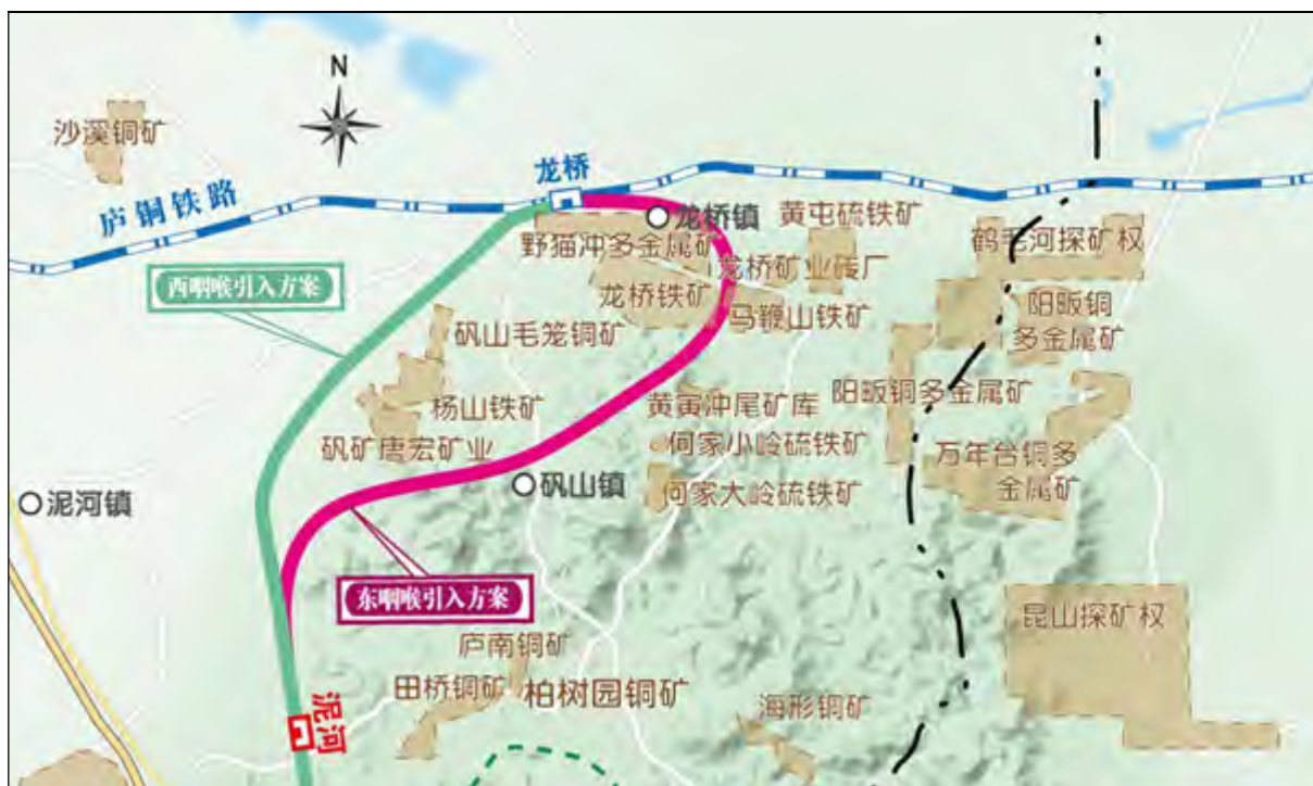
图 2.7-5 龙桥站接轨布置示意图
