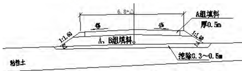
低路堤 ( 0.5\text{m} < h \leq 1.5\text{m} ) 标准横断面示意图
